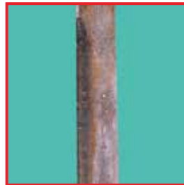
Knochenstanze, Gleitfläche des Schieberteiles zeigt Reibkorrosionserscheinungen
