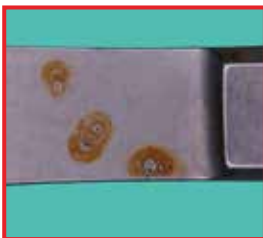
Detail Pinzette: Übergang Feder/Grifffläche. Chloridhaltiges Regeneriersalz führte zu massivem Lochkorrosionsbefall auf der Instrumentenoberfläche. Ursache: undichter Anschluss des Ionenaustauschers im RDG.
