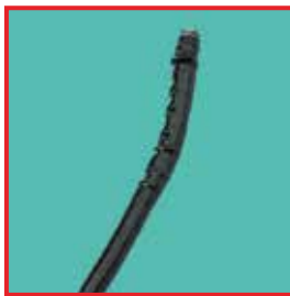
Aufquellung am Distalende eines Fiberskops
