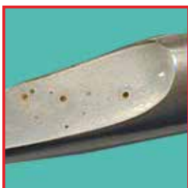
Chloridinduzierte Lochkorrosion auf dem Instrument.
